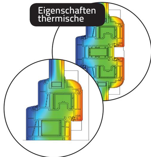
\* für ein Referenzfenster breit 1230 mm, hoch 1480 mit Verglasungspaket 44 mm /  $U_g=0,6 \text{ W/m}^2\text{K}$  und mit Distanzrahmen Swisspacer V
