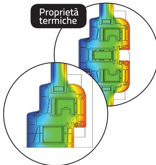
\*per un'infisso di riferimento larghezza 1230 mm, altezza 1480 con vetri di 44 mm/ $U_g=0,6 \text{ W/m}^2\text{K}$  e distanziatore Swisspacer V
